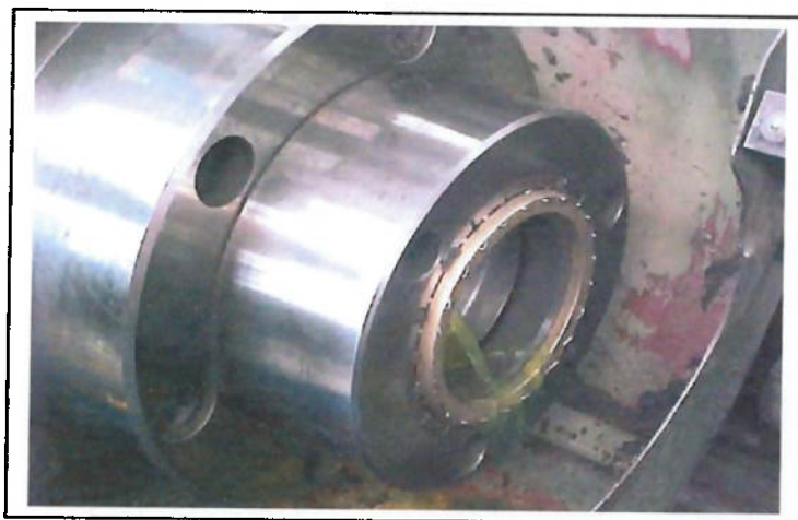
Figura 19. Pinça auto-centrante com peça fixada por gaiola
