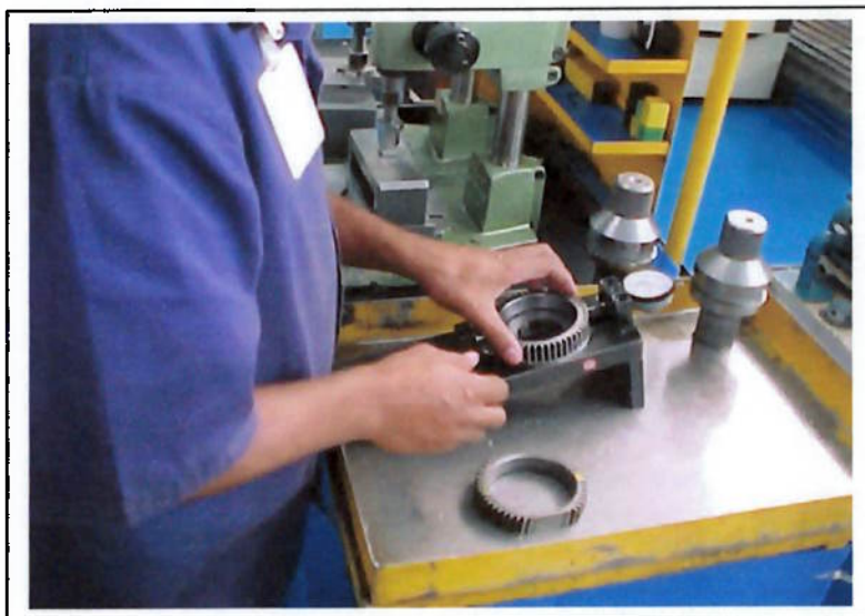
Figura 22. Controle da medida sobre esferas
